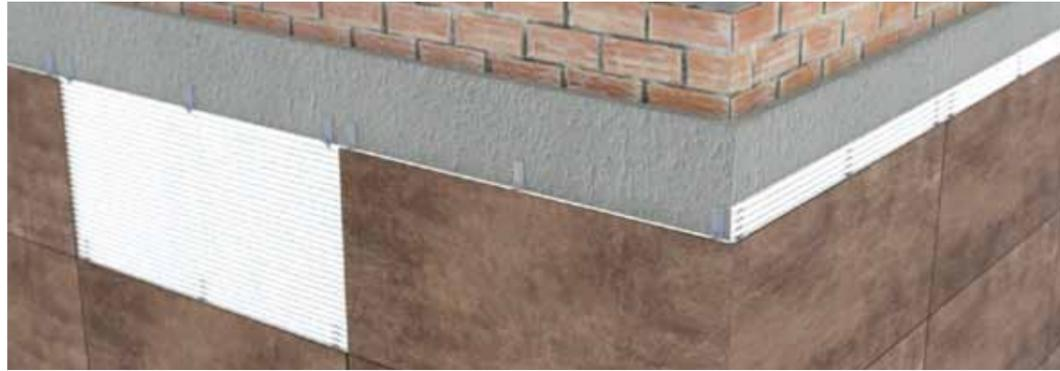
SISTEMA DE COLOCACIÓN CON JUNTA MÍNIMA DE 10 mm
