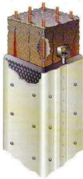
Fig. 5.43. Sistema de galvanico de protección.
