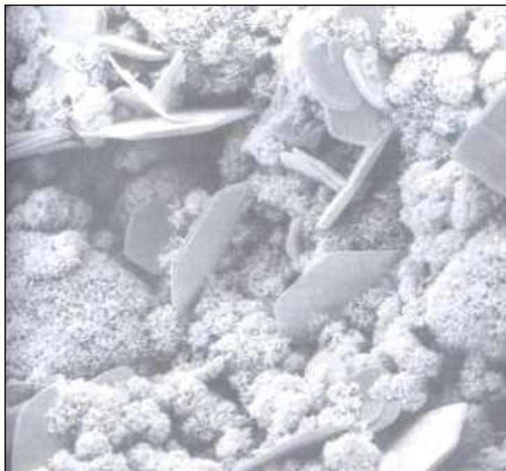
Fig. 2.10. Pasta de cemento hidratada:  $\text{Ca}(\text{OH})_2$  y C-S-H.
