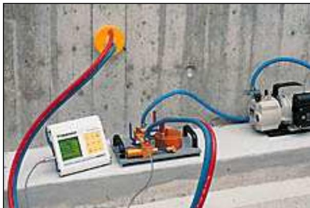
Fig. 5.23. Imagen del equipo Torrent.
